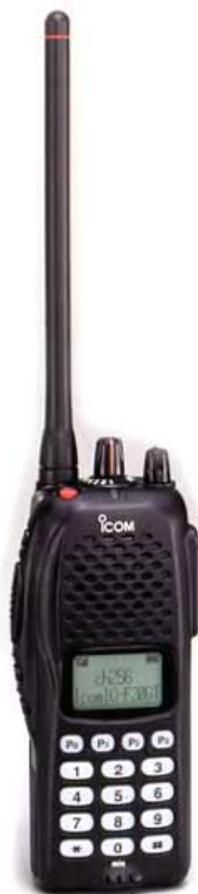
È un ricetrasmittitore particolarmente studiato per un utilizzo professionale che risponde al protocollo analogico della CRI, è un apparato in grado di erogare una potenza massima di 5W. Il ricetrasmittitore **IC-F31GTN** della Icom è costruito con un corpo in alluminio pressofuso e pannello frontale in policarbonato ed è resistente a forti vibrazioni od urti.
