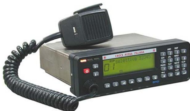
È uno degli apparati in dotazione alla Croce Rossa Italiana prodotto dalla EMC S.p.A. modello WARD-V160 operante sulla gamma di frequenza 146-174 MHz, con una potenza di uscita di 10 W.
